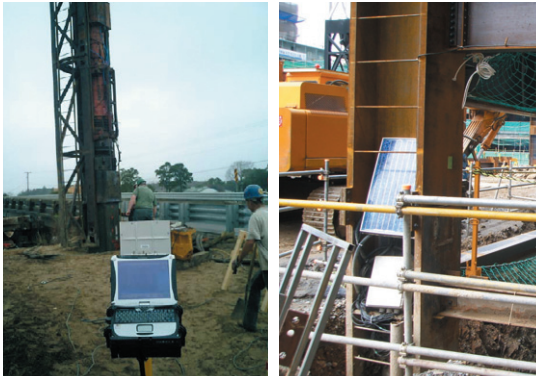
(a) 항타관입성을 무선충전기로 측정하는 장면 (말뚝 내 계측기의 배터리 전원 이용) (b) 현타말뚝의 하중전이를 자동 측정하는 장면(말뚝위부 설치한 태양열 전원 이용)
