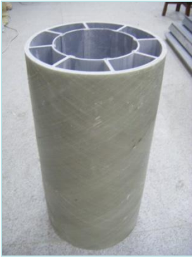
폐합 및 개방 단면 펄트루전 FRP를 이용한 HCFFT
